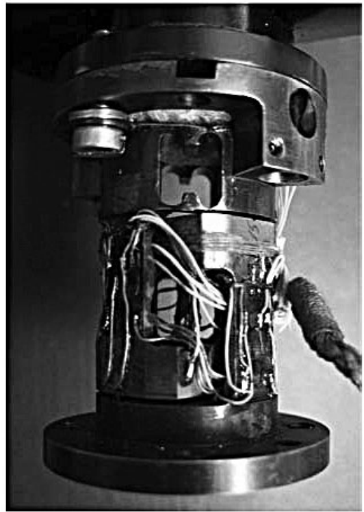
Рисунок 3 – Шести компонентный силомоментный датчик на тензорезисторах СМД (ЦНИИМаш, Россия). Справа — датчик со снятым кожухом
