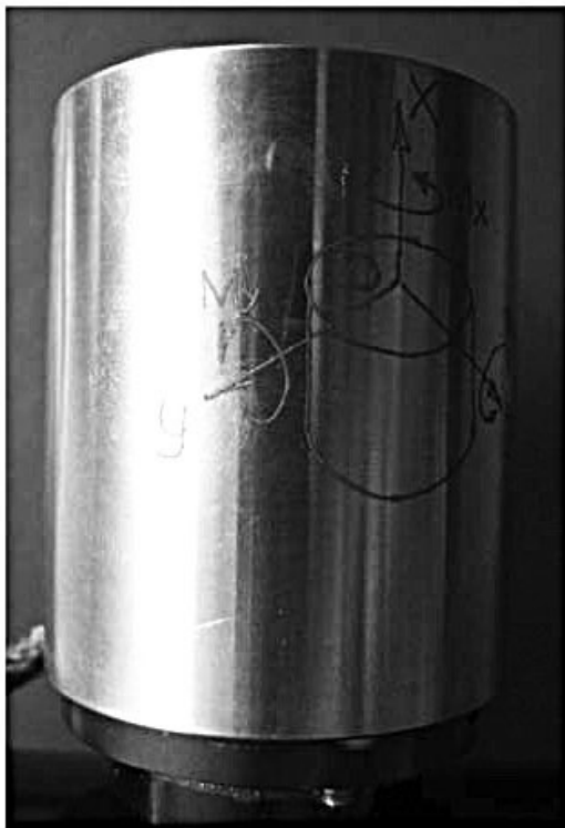
Рисунок 3 – Шести компонентный силомоментный датчик на тензорезисторах СМД (ЦНИИМаш, Россия). Справа — датчик со снятым кожухом
